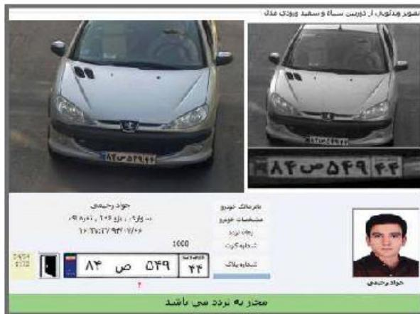
در سیستم جامع حرامت و انتظامات (دزبان) کنترل تردد خودروها توسط ماژول پارکینگ صورت می‌پذیرد، این ماژول با استفاده از دوربین‌های که در قسمت ورودی پارکینگ نصب می‌گردد، اقدام به عکسبرداری از خودروهای در حال ورود و یا خروج از پارکینگ نموده و با استفاده از تکنیکهای هوش مصنوعی اقدام به شناسایی محل قرارگیری پلاک نموده و پس از پردازش تصویر پلاک، اعداد و حرف موجود در پلاک را استخراج نموده و اقدام به ثبت تردد خودرو در بانک اطلاعاتی می‌نماید.
